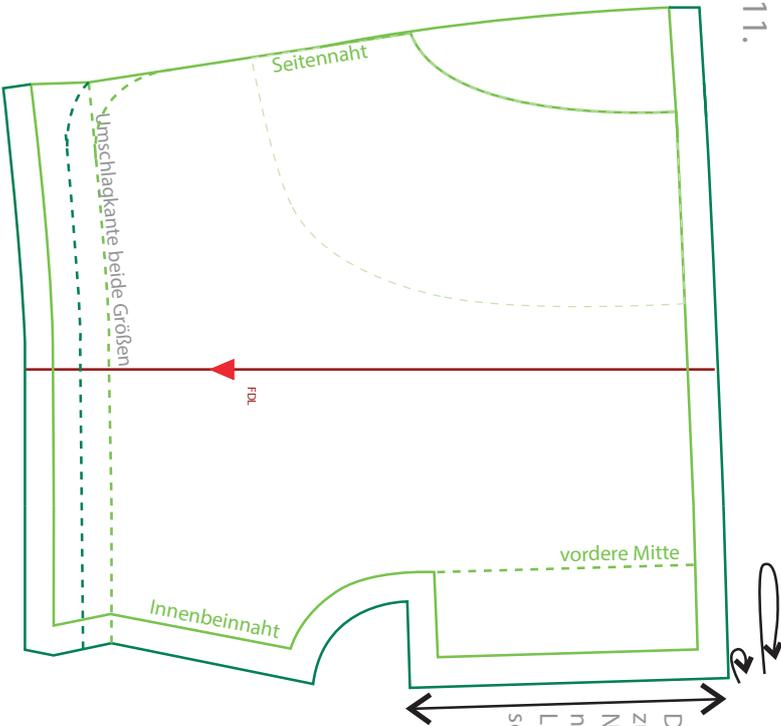
Die Vorderteile an der gerade zusammen nähen. Einen cm Nahtzugabe einschlagen, dann nochmal zusätzlich an der Linie der Vorderen Mitte einschlagen.
